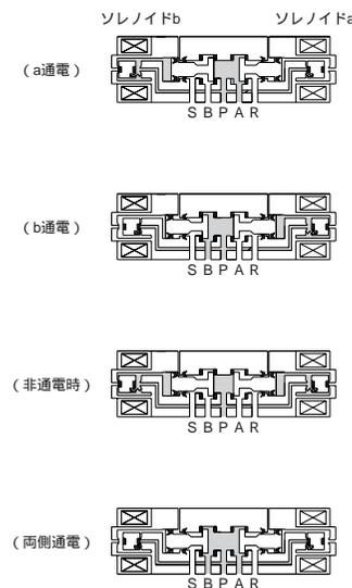
ソレノイドaに通電するとパイロット圧が排気されて右側のスプールが右へ移動してP Aにエアが流れます。ソレノイドbに通電するとP Bに切り換わります。通電を切った場合には両側のスプールが中央に移動してA, Bポートが排気状態になります。両側ソレノイドに通電した場合には、左右のスプールが外側に移動してA, Bポートは加圧状態になります。
