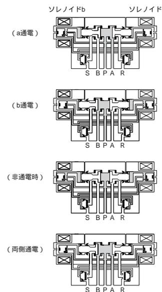
ソレノイドaに通電するとパイロット圧が排気されて右側のスプールが右側へ移動してP Aにエアが流れます。その時クローズして配管してあるパイロット圧力が排気されてSポートを閉じているピストンが開いてBポートの排気が流れます。ソレノイドbに通電するとP Aに切り換わります。通電を切った場合にはS・Rポートがピストンによって閉じられA・Bポートはクローズ状態になります。両側ソレノイドに通電した場合にはA・Bポートは加圧状態になります。
