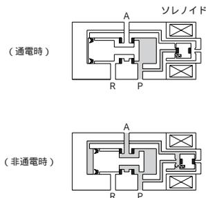
ソレノイドに通電するとパイロット圧が排気されてスプールは左側へ移動してP圧はクローズされます。通電を切るとスプールが右側へ移動してP Aにエアが流れます。停電時、電気回路遮断時には非通电時の位置へ復帰します。
