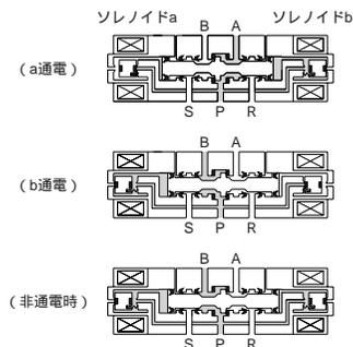
ソレノイドaに通電するとパイロット圧が排気されてスプールは左側へ移動してP Aにエアが流れます。ソレノイドbに通電した場合にはP Bに切り換わります。停電時、電気回路遮断時にはその位置を保持します。
