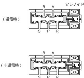
ソレノイドに通電するとパイロット圧が排気されて、スプールは左側へ移動してP Aにエアが流れます。通電を切るとパイロット圧が供給されて左右のピストンの面積差によってスプールは右へ移動してP Bに切り換わります。停電時、電気回路遮断時には非通电時の位置へ復帰します。
