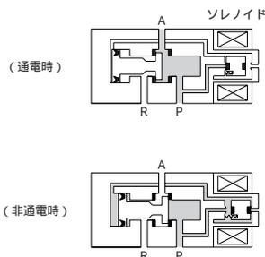
ソレノイドに通電するとパイロット圧が排気されてスプールは左側へ移動してP Aにエアが流れます。通電を切るとスプールが右側へ移動してP圧はクローズされます。停電時、電気回路遮断時には非通电時の位置へ復帰します。
