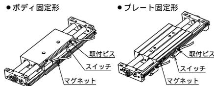
1. スwitchの取付ビスを緩めて、スイッチを任意の検出位置までスライドさせてください。ストローク端検出および検出ストロークの調整範囲は外形寸法図を参照してください。スイッチの最高感度位置にマグネットが位置する様に設定すると最も安定して検出できます。
